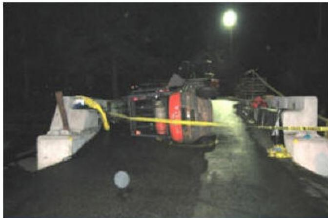
Esta fotografía muestra la escena de un accidente fatal ocurrido cuando un montacargas volcó y el operador pensó que podía dar un salto para salir. No lo logró. Quedó aplastado entre la barra antivuelco del montacargas y el piso de concreto. No estaba usando el cinturón de seguridad.
